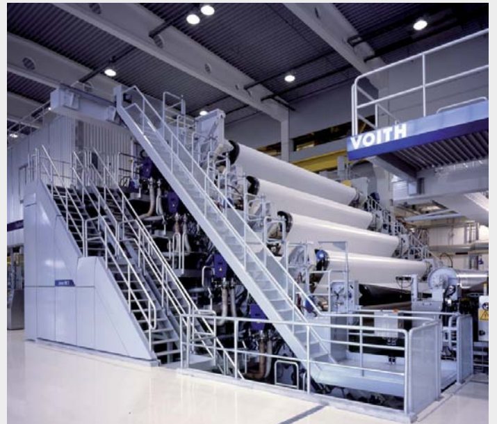
Eine Veredler-Maschine – genauer: ein Janus Kalender – bei der Voith Paper GmbH in Krefeld
